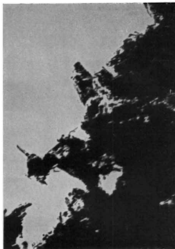
Abb. 3. Platinschwamm aus Ammoniumplatinchlorid. (Vergrößerung 75 000 fach.)
